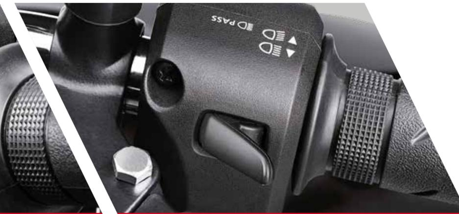
**INTEGRATED HEADLAMP BEAM & PASSING SWITCH**
